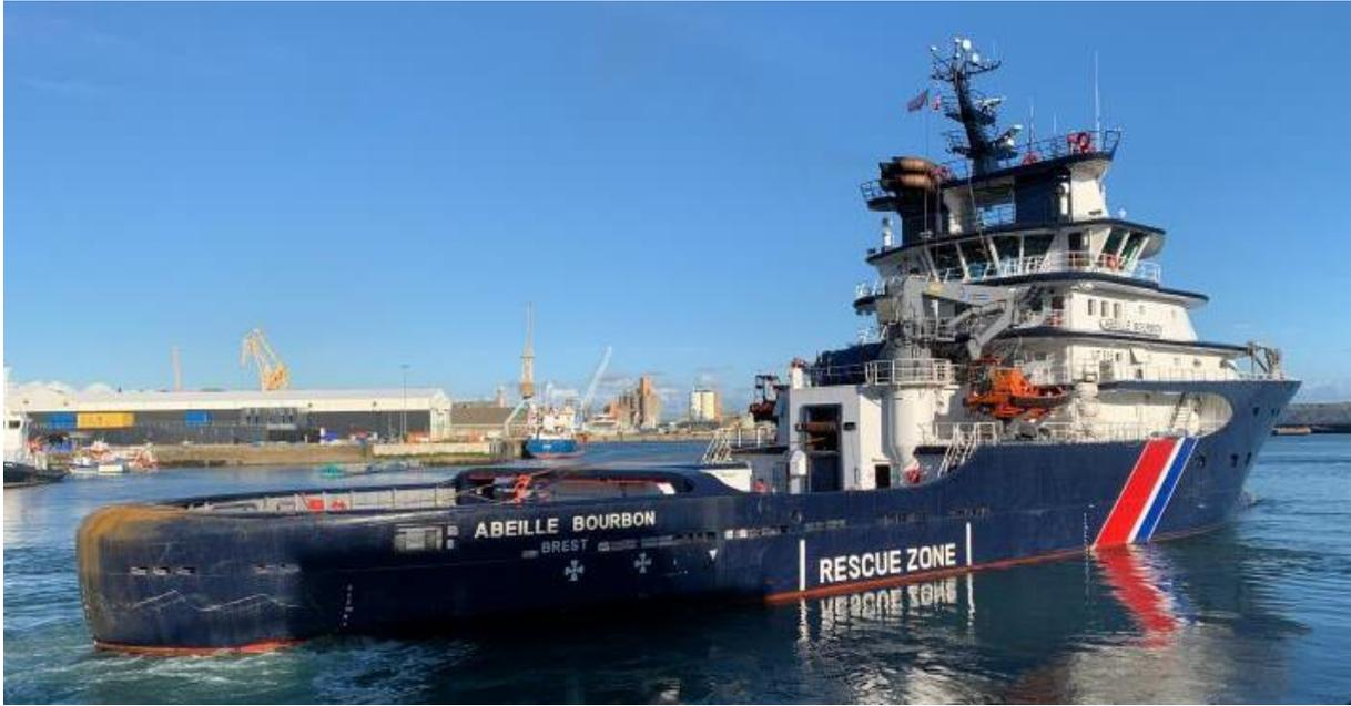
C'est un navire de remorquage d'urgence - remorqueur d'intervention, d'assistance et de sauvetage (RIAS) - long de 80 mètres avec une force de traction de 200 tonnes, 12 hommes d'équipage, conçu par l'architecte naval norvégien Sigmund Borgundvaag et construit par Kleven Maritim. Il est basé à Brest et assure la sécurité maritime du rail d'Ouessant.
