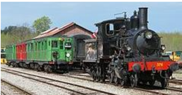
Loco 130 à tender séparé devant la rame SPRAGHE
